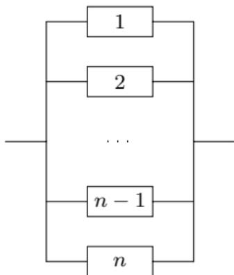
Pour un système constitués de  $n$  composants montés en parallèles (le bon fonctionnement de chacun étant indépendant du bon fonctionnement des autres), on montre que l'on a
