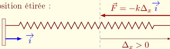
Pour mettre en évidence la structure mathématique du phénomène ondulatoire, nous allons étudier le système constitué d'une chaîne infinie d'oscillateurs identiques composés de masses  $m$  et de ressorts de raideurs  $k$  montés en série :
