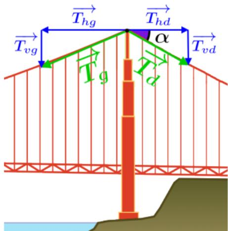
Dans la représentation ci-dessus, le câble porteur exerce sur la pile une tension  $\vec{T}_g$  ayant une composante horizontale  $\vec{T}_{hg}$  et une composante verticale  $\vec{T}_{vg}$ .
