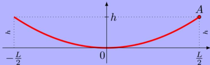
où l'équation du câble porteur est  $y(x) = \frac{Mg}{2T_h L} x^2$ , démontre que :
