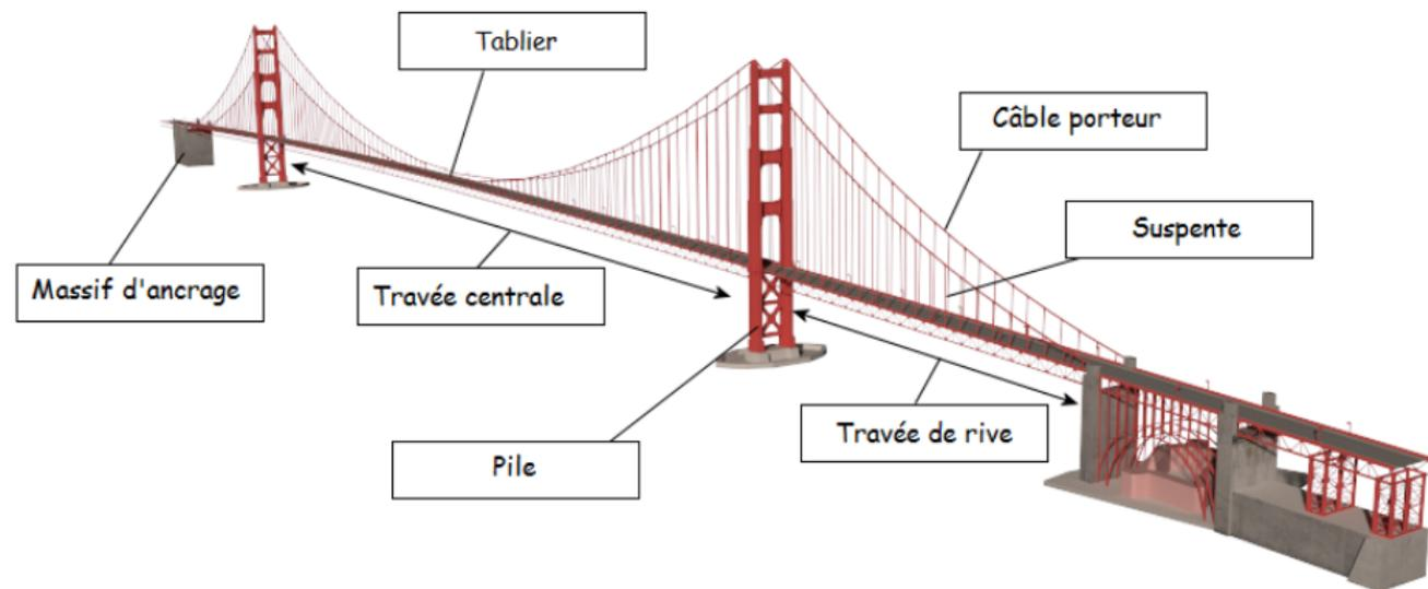
Le tablier d'un pont est la structure porteuse qui supporte les charges du trafic routier et les transmet aux éléments de suspension, ici les suspentes.
