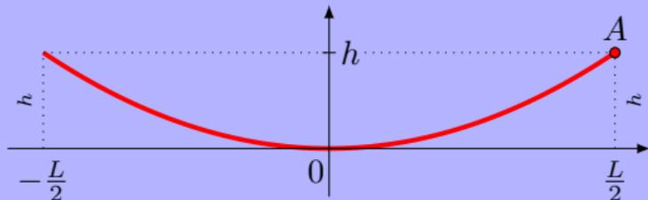
où l'équation du câble porteur est  $y(x) = \frac{Mg}{2T_h L} x^2$ , démontre que :
