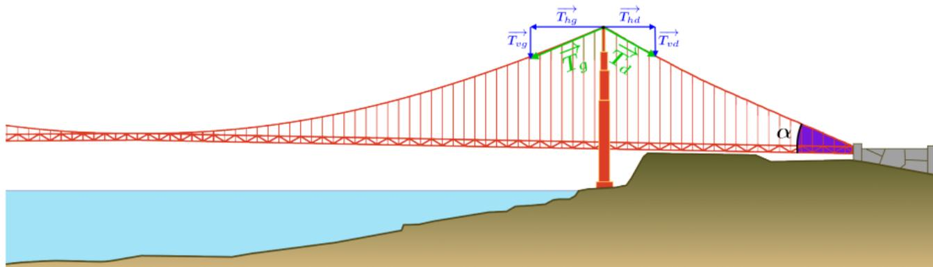
Le rôle essentiel du câble porteur est de transmettre aux appuis les efforts en tension aux piles du pont.
