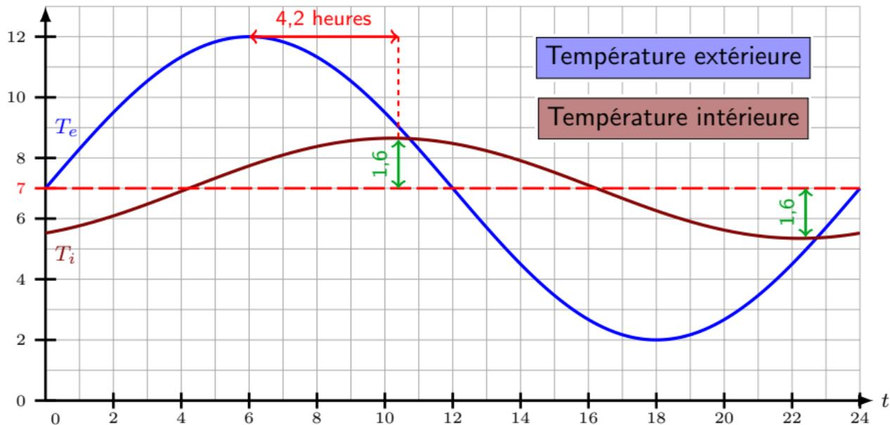
On observe un déphasage de **4,2 heures** entre la température extérieure ( $T_e$ ) et la température intérieure ( $T_i$ ) :
