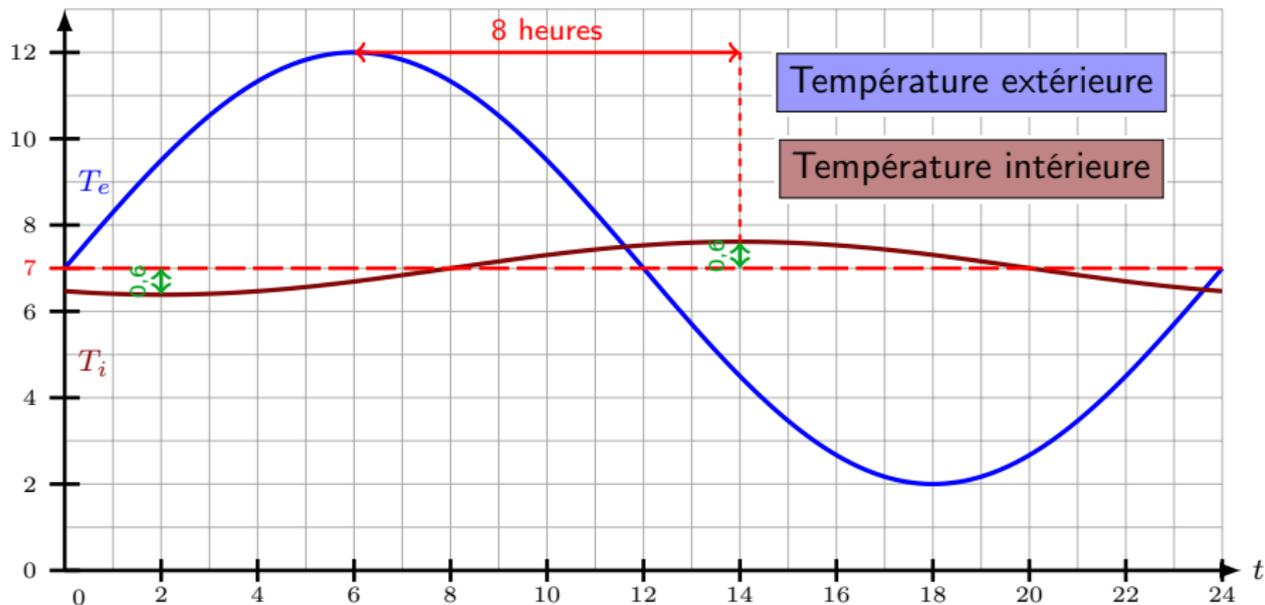
On observe un déphasage de **8 heures** entre la température extérieure ( $T_e$ ) et la température intérieure ( $T_i$ ) :
